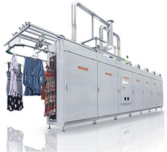
Паровая камера с двумя роликами на входе и скользящая дверца разгрузки позволяют существенно экономить потребление электроэнергии.
