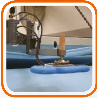
Stiro collo/etichetta vaporizzante, singolo o doppio. Single or double collar/label fini- sher (steaming)
